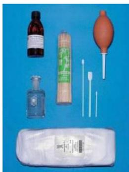
1、溶剂（乙醇与乙醚以 1:2 的比例混合）； 2、棉签； 3、无尘布； 4、洗耳球；
